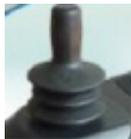
La dirección de movimiento de la silla de ruedas se controla mediante el joystick. La amplitud de movimiento del joystick también controla la velocidad de movimiento.
